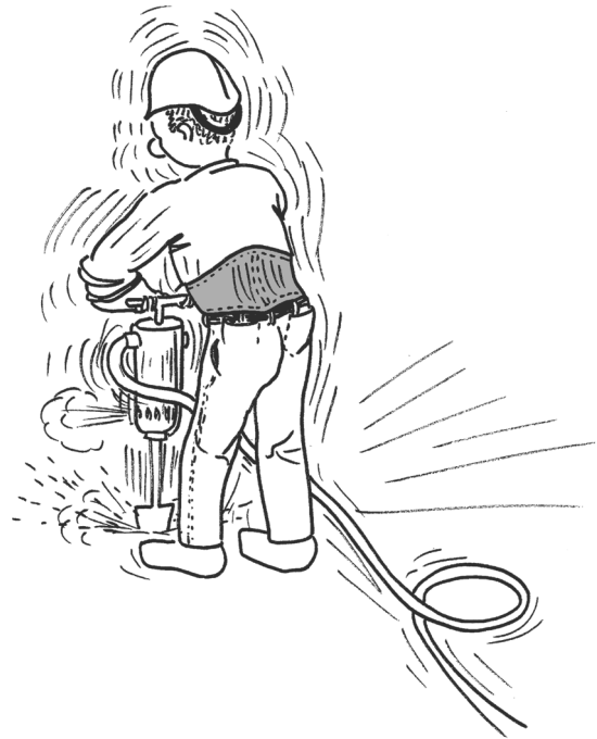
Figura 14.58 As vibrações são comuns em algumas profissões e podem exigir o uso de uma faixa.
